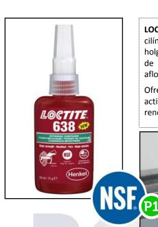
**LOCTITE 638** está diseñado para la unión de componentes cilíndricos ajustados, especialmente adecuado allí donde las holguras puedan alcanzar 0,25 mm. El producto cura en ausencia de aire, entre superficies metálicas ajustadas, evitando el aflojamiento y las fugas producidas por impactos y/o vibraciones.
