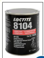
LOCTITE LB 8104 es una grasa transparente en base de silicona espesada con gel de sílice. Ofrece un amplio intervalo térmico operativo (hasta +200 °C) y lubrica la mayoría de plásticos y elastómeros. Está certificado por NSF categoría H1 registro n.º 122981 y presenta el grado 2/3 en la clasificación NLGI.
