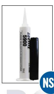
LOCTITE SI 5900 es una pasta tixotrópica en base silicona de baja resistencia y curado por humedad. Algunas de sus aplicaciones típicas incluyen las tapas de metal estampado (tapas de la distribución y cárteres de aceite). Presenta rápida formación de piel 15 min, y es adecuada para rellenar holguras de hasta 1 mm.
