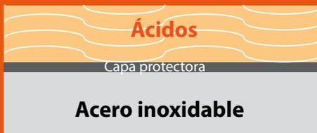
Cuando un acero inoxidable está en contacto prolongado con un ácido fuerte, la capa protectora formada en su superficie se disuelve rápidamente.
