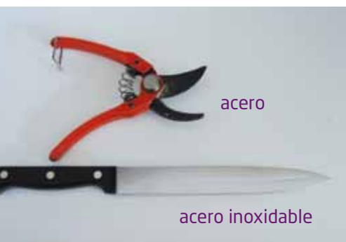
Al contacto con la humedad del aire o del agua el acero se oxida, cosa que no sucede con el acero inoxidable al contener cromo.
